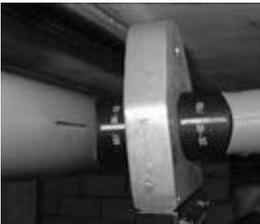
Aufschweiss-Sattel und Rohr gleichzeitig auf Heizbuchsen aufschieben.
